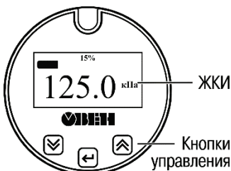
Рисунок 4.3 – Лицевая панель нормирующего преобразователя
